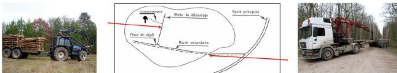
Figure 8 : hiérarchie des types de routes en forêt, et engin les empruntant (CRPF IDF, 2013)
