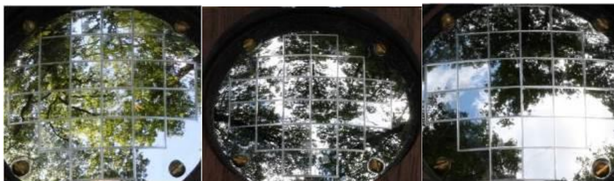
Figure 13 : extrait des exercices de comptage à l'aide d'un densiomètre (de gauche à droite, estimation du couvert forestier : 90 %, 80 % et 60 %) (Source : Université catholique de Louvain)
